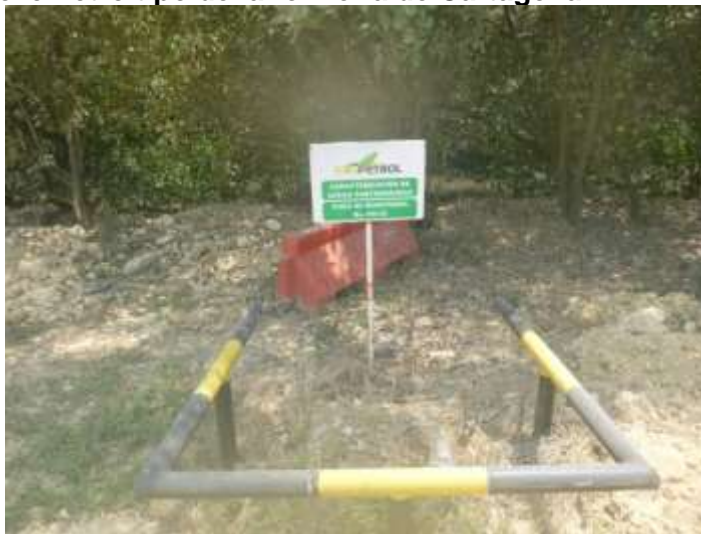
Fotografía 3.1 Piezómetro tipo de la refinería de Cartagena
